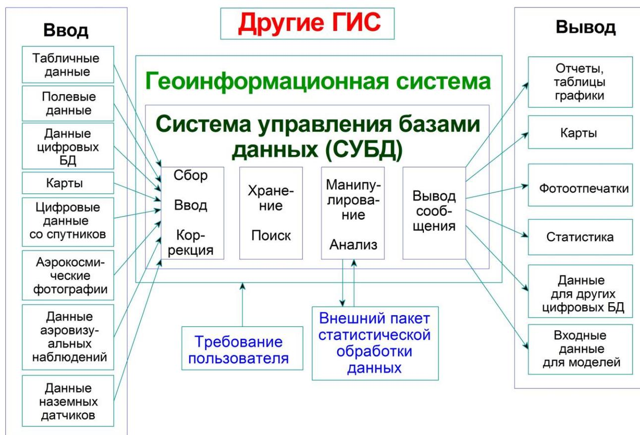
Рисунок 5 – Общая схема функционирования геоинформационной системы
